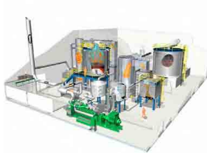
Figur 19: Kombinert kraft- og varmeverk basert på biogass fra avfall.
